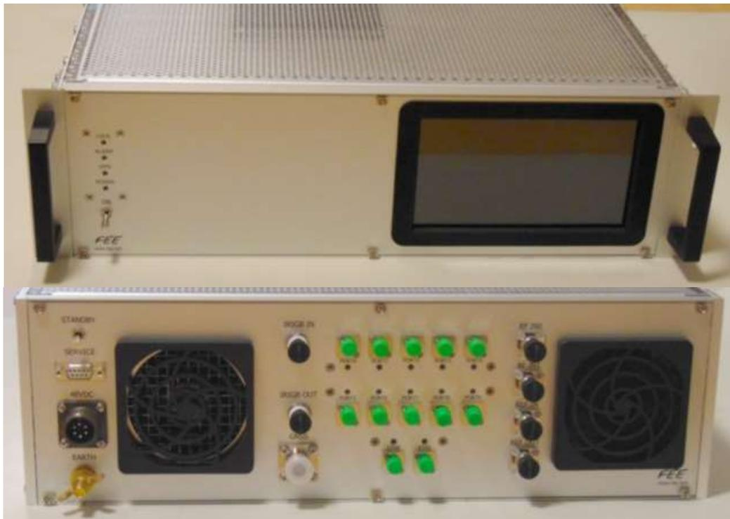
Un écran tactile en face avant permet la configuration et la visualisation des signaux internes. Des options sont proposées pour des références de fréquence internes de haute stabilité. L'alimentation requise est 48V...60VDC, pour une consommation d'environ 50W (selon options). Une double entrée d'alimentation permet la redondance.
