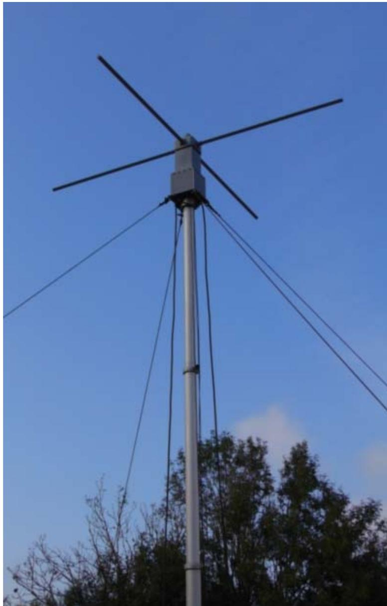
DHADI - Double dipôle horizontal HF sur mât de 6m (prototype)
